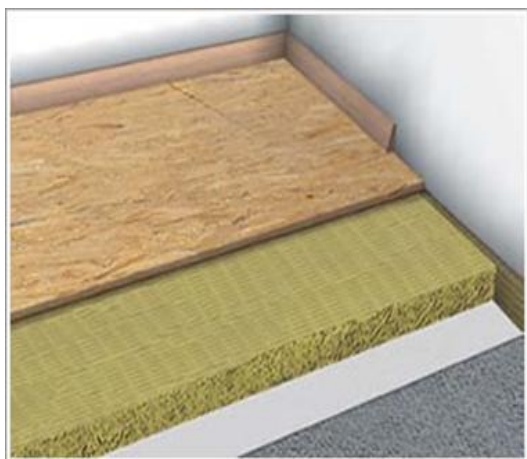
Slika 2.3.a Postavljanje toplotne izolacije na pod negrijanog tavana
